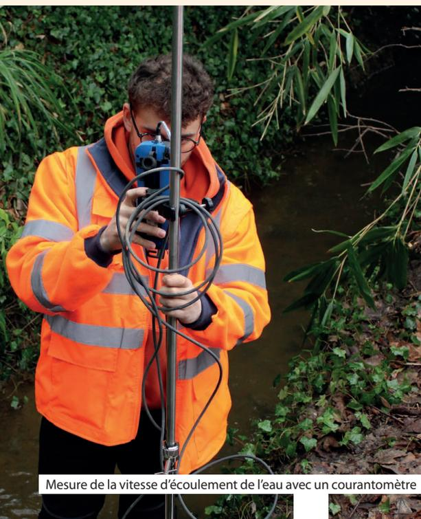
Mesure de la vitesse d'écoulement de l'eau avec un courantomètre
