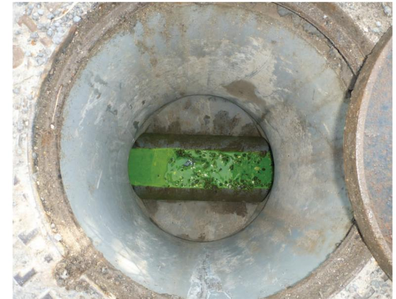
Contrôle de conformité à la fluorescéine, permettant de suivre les eaux usées
