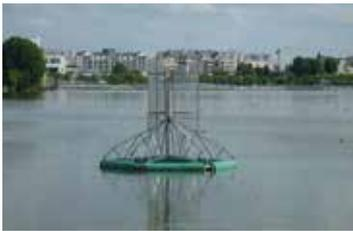
Conçue par Aéroloc, l'hydrolienne soutenue par six flotteurs représente pas moins de 3,6 m de haut. Son fonctionnement a l'avantage d'être simple et de ne nécessiter ni ajout de substance chimique, ni consommation d'énergie : une hélice immergée est
